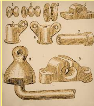
1885 Elektroisolatoren aus Porzellan (La physique moderne. L'électricité dans la maison, É. Hospitalier)
