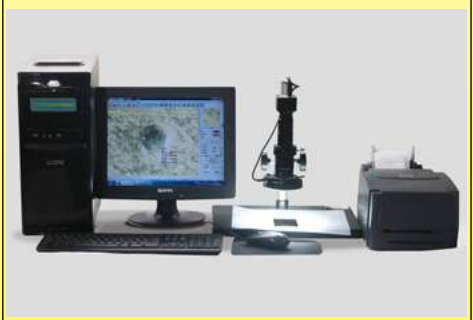
Elektronenmikroskopische Messung des Kerbdurchmessers (Ultimheat Labor)
