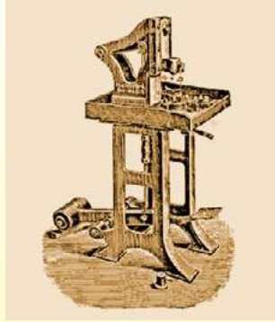
Pedalpresse für elektrisches Porzellan aus Deutschland (1905 La Céramique Industrielle, A. Granger, Ultimheat Museum)
