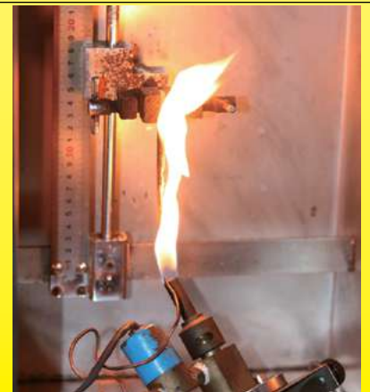
Prüflinge während der Prüfung laut UL94 V-0
